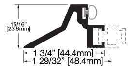
**Operation:** Thermal Break Threshold
